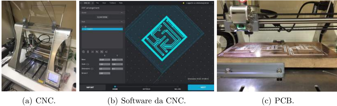
Figura 8.11: Desenvolvimento do circuito condicionador de sinais.
