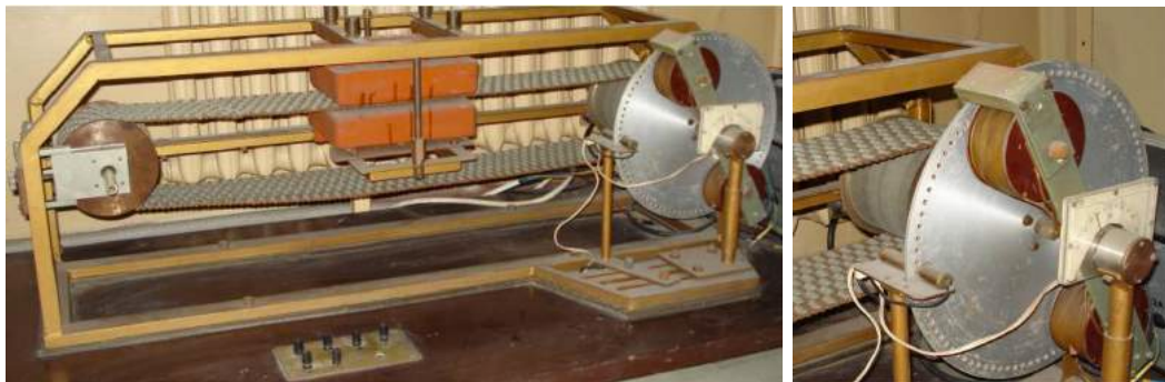
(a) Bancada do MIL com secundário tipo esteira.
