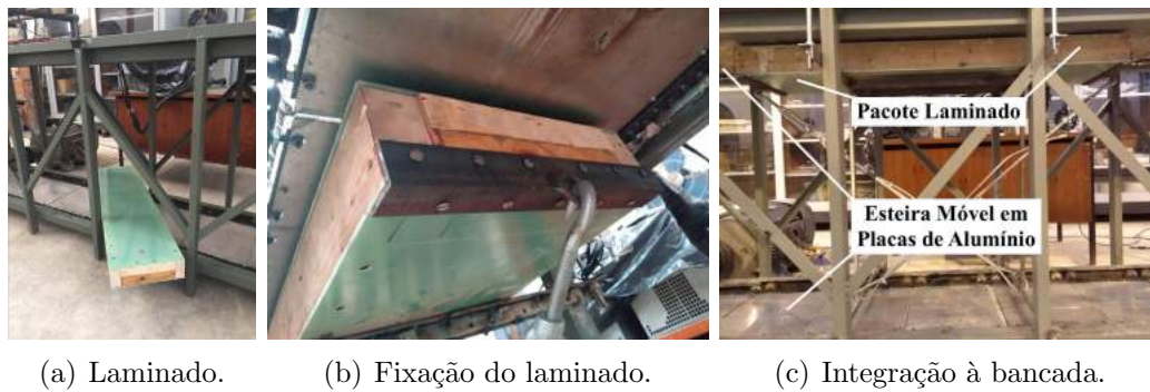
Figura 8.13: Pacote laminado do secundário da STRATUM .
