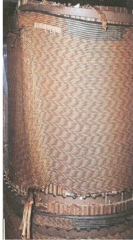
Figura 5-13 – Encurvamento do enrolamento e efeito axial de curto-circuito
