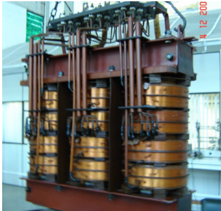
Figura 6.2 – Detalhe dos enrolamentos de alta tensão.
