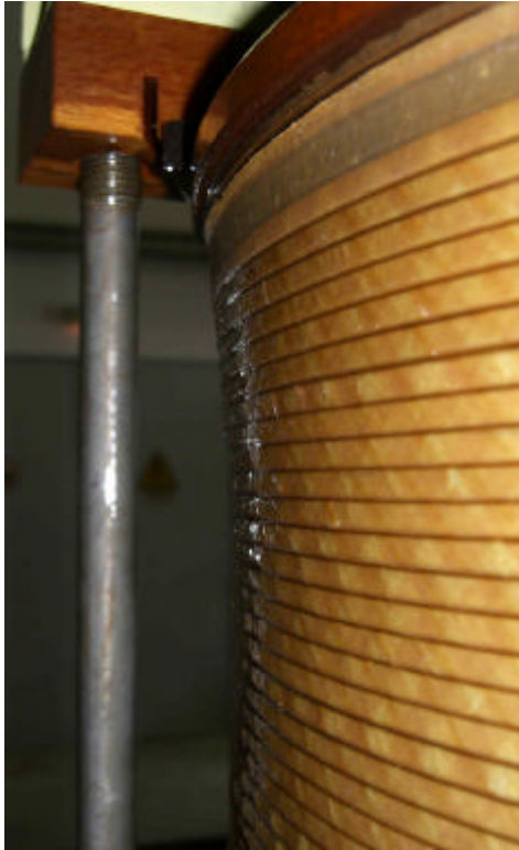
Figura 5-13 – Encurvamento do enrolamento e efeito axial de curto-circuito
