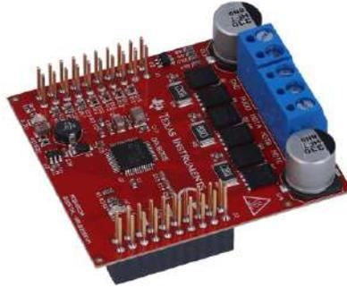
Figura 3.20: Micro inversor de frequência utilizado para experimento em bancada. [41]
