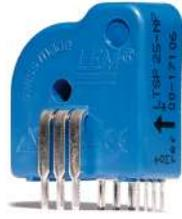
Figura 3.18: Sensor de corrente utilizado no circuito desenvolvido.
