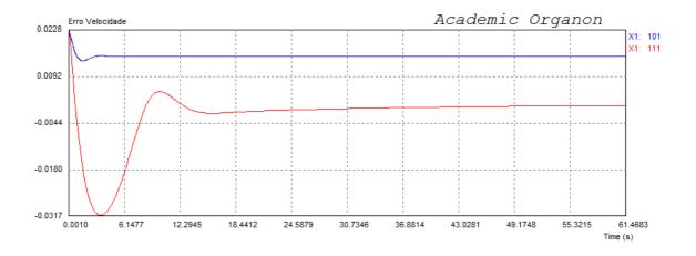
Figura VI.34 – Erro de velocidade da turbina a gás.
