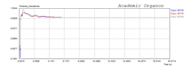
Figura VI.10 - Tensões nas barras de geração 90169 (vapor), 90130 e 90136 (gás)
