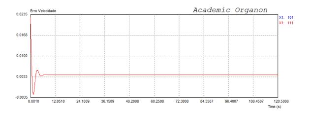
Figura VI.52 – Erro de velocidade da turbina a gás.
