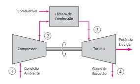
Figura III.2 - Ciclo aberto de turbinas a gás [12]
