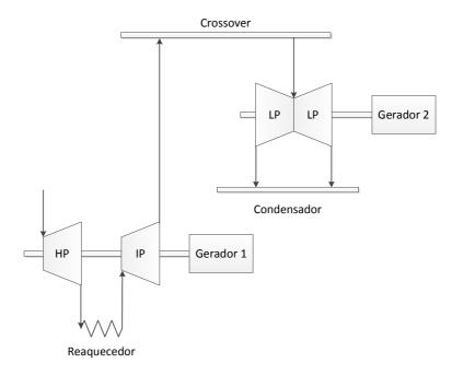
Figura III.8 – Turbina de único reaquecimento cross-compound
