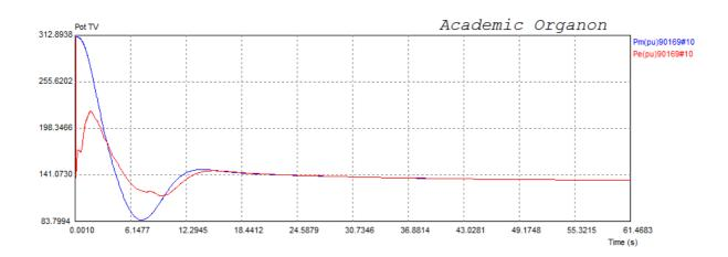
Figura VI.27 – Potência elétrica e mecânica da unidade a vapor.
