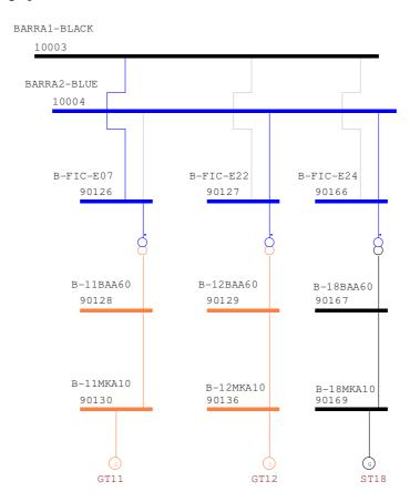
Figura VII.10 - Diagrama Unifilar da TKCSA - Rede TERMELÉTRICA
