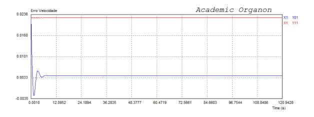
Figura VI.43 - Erro de velocidade da turbina a gás.
