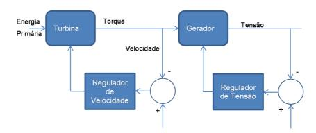
Figura I.1 – Diagrama simplificado dos sistemas de controle de um gerador síncrono
