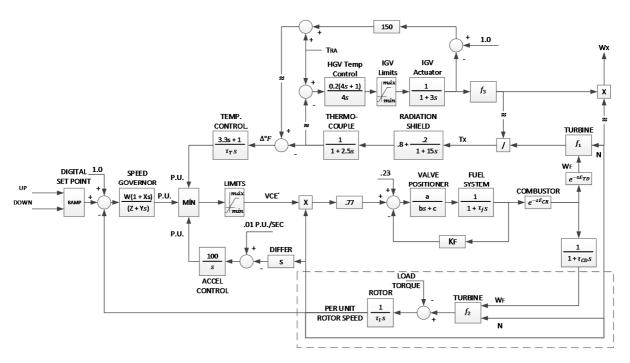
Figura I.4 – Representação matemática simplificada da TG de eixo simples com acionamento mecânico e controle de IGV
