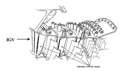
Figura III.4 – Detalhe do IGV (Inlet Guide Vane) [5]
