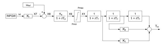
Figura VII.14 – Modelo simplificado de turbina a vapor e regulador de velocidade
