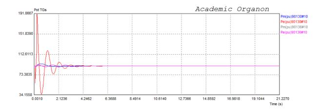
Figura VI.17 – Potência elétrica e mecânica das unidades a gás.
