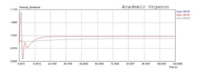
Figura VI.46 – Tensões nas barras de geração 90169 (vapor), 90130 e 90136 (gás)
