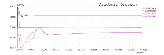
Figura VI.26 – Potência elétrica e mecânica das unidades a gás.
