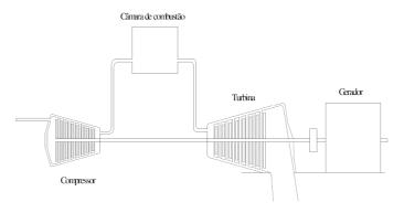
Figura IV.1 – Diagrama de uma turbina a gás operando em ciclo aberto [27]
