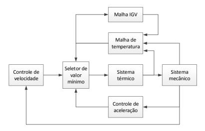
Figura IV.3 – Diagrama funcional da operação em ciclo aberto para turbina a gás – representação dos principais controladores.
