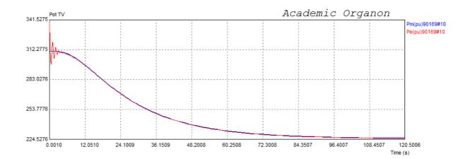
Figura VI.45 – Potência elétrica e mecânica da unidade a vapor.
