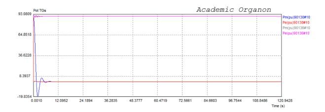
Figura VI.35 – Potência elétrica e mecânica das unidades a gás.
