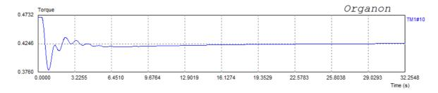
Figura VII.16 – Resposta de turbina a vapor para um curto-circuito e perda de ramo.
