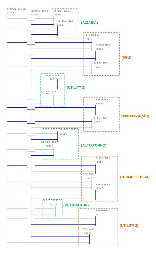
Figura VII.3 - Diagrama Unifilar da TKCSA - Rede Interna
