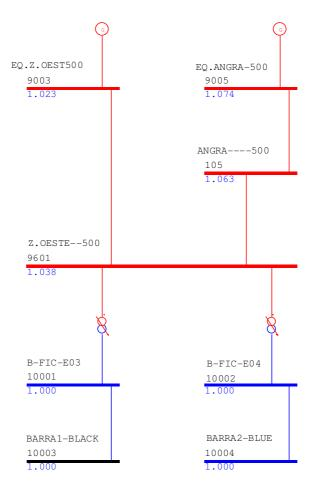
Figura VII.2 - Diagrama Unifilar da TKCSA - Acesso ao SIN
