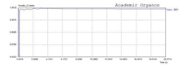
Figura VI.9 - Tensão na barra 9601 da SE Zona Oeste 500 kV
