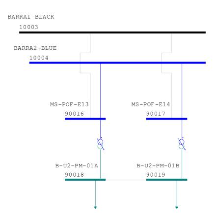
Figura VII.6 - Diagrama Unifilar da TKCSA - Rede UTILITY 2
