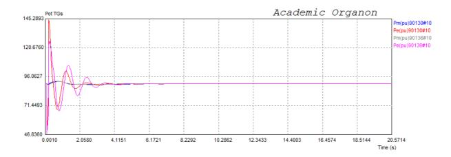
Figura VI.7 - Potência elétrica e mecânica das unidades a gás.
