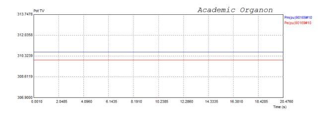
Figura VI.2 – Resposta em regime do gerador da turbina a vapor.
