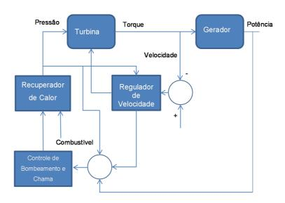
Figura I.2 – Diagrama simplificado do controle de potência de usinas termoelétricas a vapor
