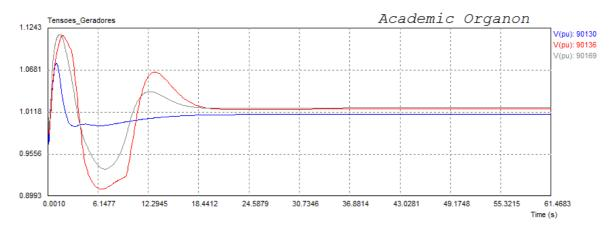
Figura VI.28 – Tensões nas barras de geração 90169 (vapor), 90130 e 90136 (gás)
