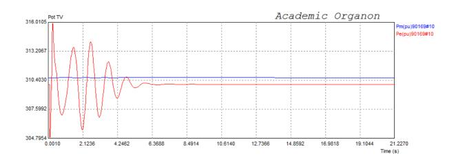
Figura VI.18 – Potência elétrica e mecânica da unidade a vapor.
