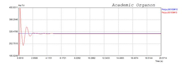
Figura VI.8 – Potência elétrica e mecânica da unidade a vapor.
