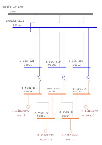
Figura VII.4 - Diagrama Unifilar da TKCSA - Rede ASU
