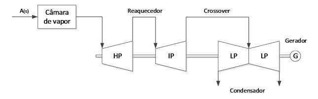
Figura IV.28 - Diagrama esquemático da configuração tandem-compound com reaquecimento
