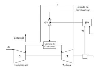
Figura IV.2 – Diagrama funcional de uma turbina a gás operando em ciclo aberto [27]
