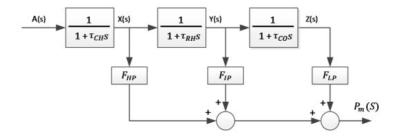
Figura IV.29 – Diagrama de blocos da configuração tandem-compound com reaquecimento
