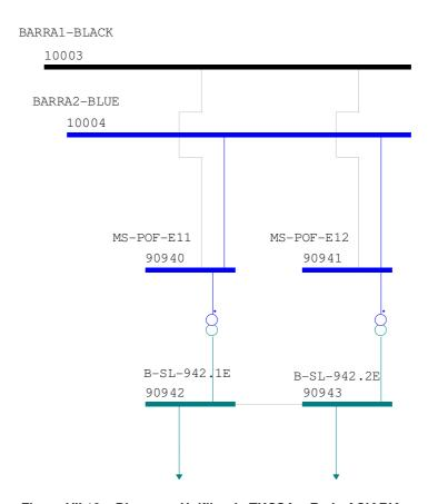
Figura VII.13 – Diagrama Unifilar da TKCSA – Rede ACIARIA
