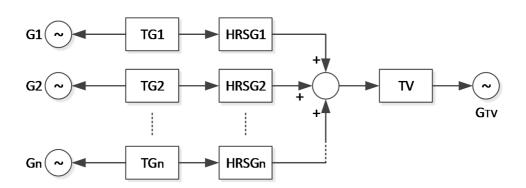
Figura IV.30 – Diagrama da configuração geral de múltiplos eixos da operação em ciclo combinado
