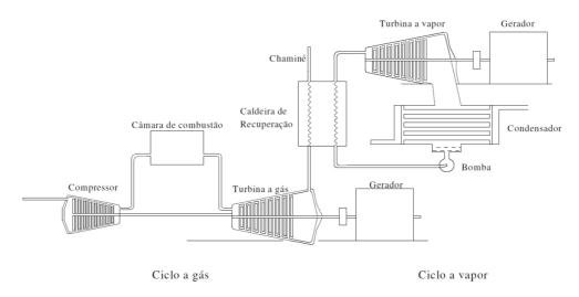
Figura III.1 – Esquema simplificado do ciclo combinado [4]
