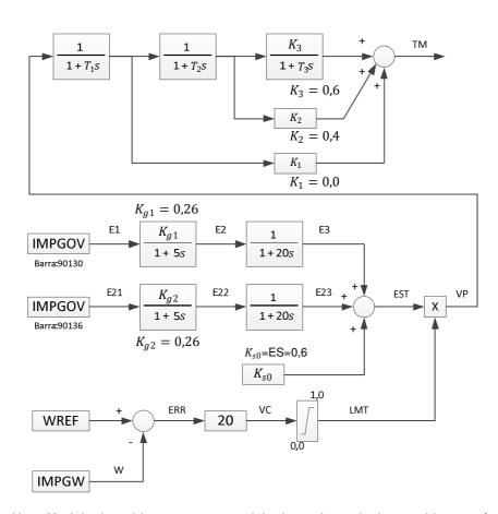
Figura V.1 – Modelo de turbine a vapor com ciclo dependente de duas turbinas a gás
