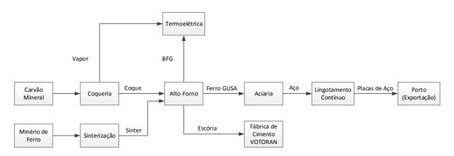
Figura II.1 – Processo de Produção do Aço – Usina Integrada
