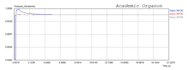
Figura VI.19 – Tensões nas barras de geração 90169 (vapor), 90130 e 90136 (gás)
