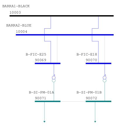
Figura VII.7 – Diagrama Unifilar da TKCSA – Rede SINTERIZAÇÃO
