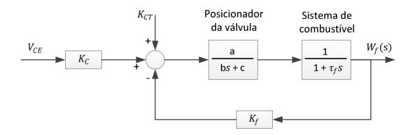
Figura IV.10 - Diagrama de blocos do sistema de combustível e posicionador da válvula
