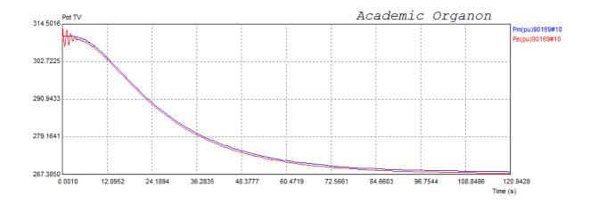
Figura VI.36 – Potência elétrica e mecânica da unidade a vapor.
