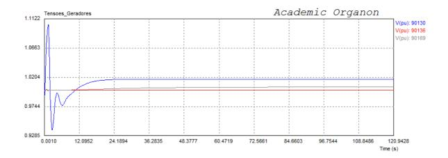
Figura VI.37 – Tensões nas barras de geração 90169 (vapor), 90130 e 90136 (gás)
