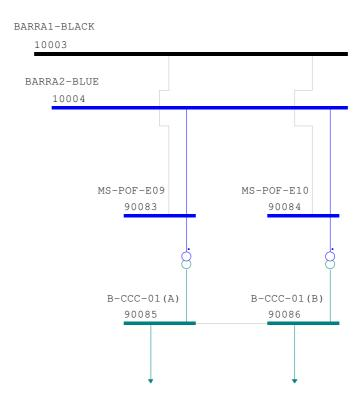
Figura VII.8 – Diagrama Unifilar da TKCSA – Rede ALTO FORNO
