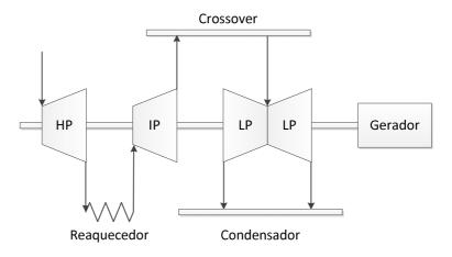
Figura III.7 – Turbina de único reaquecimento tandem-compound
