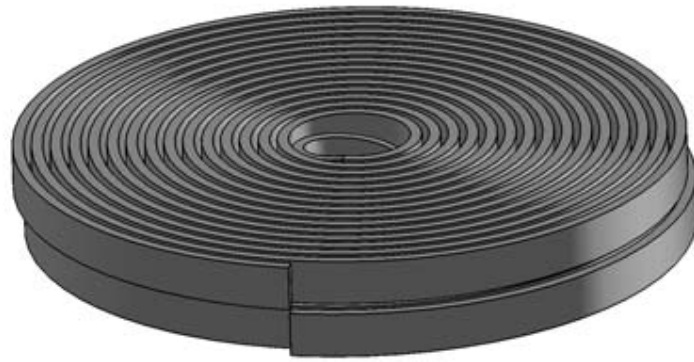
Figura 5.4: Ilustração de uma bobina supercondutora de dupla camada para a aplicação de mancais magnéticos.
