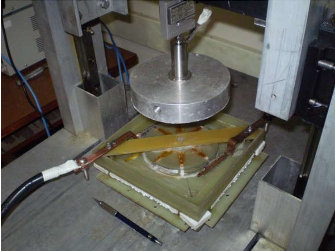
Figura 4.4: Terminais de cobre soldados na Bobina 1.
