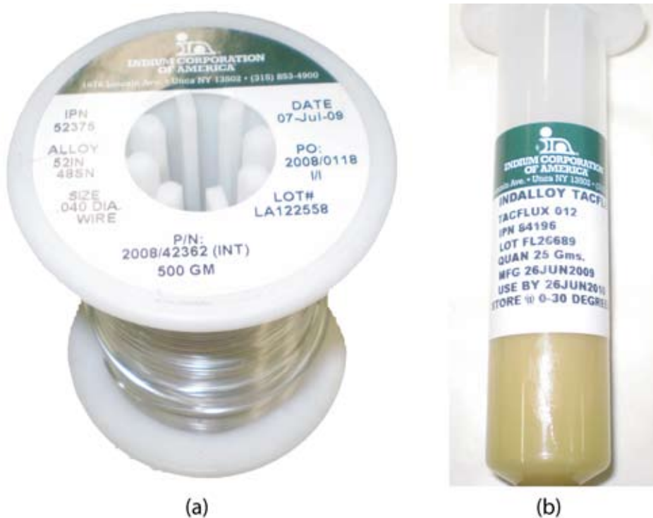
Figura 3.2: (a) Solda de baixo ponto de fusão e (b) fluxo de solda.
