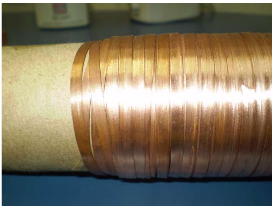
Figura 3.9: Fita de cobre obtida no processo de laminação.
