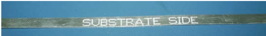
Figura 3.1: Marcação da AMSC indicando o lado do substrato nos supercondutores 344C.
