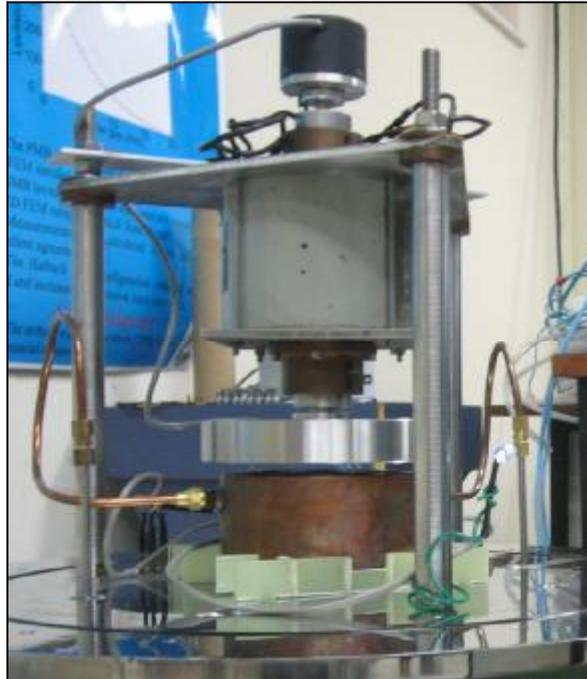
Figura A.6 – foto ilustrativa do motor de relutância variável com disco de inércia e encoder acoplados – sistema *flywheel*.
