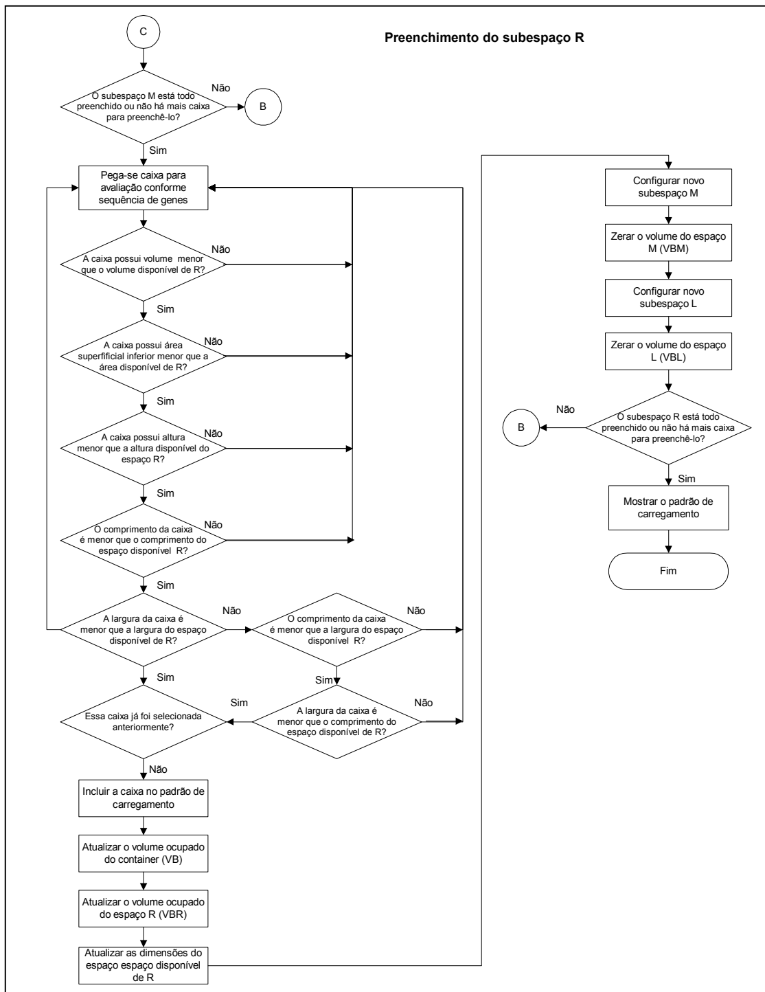
Figura 14 - Processo de seleção de caixas e preenchimento de subespaços R, da seqüência L, M e R.
