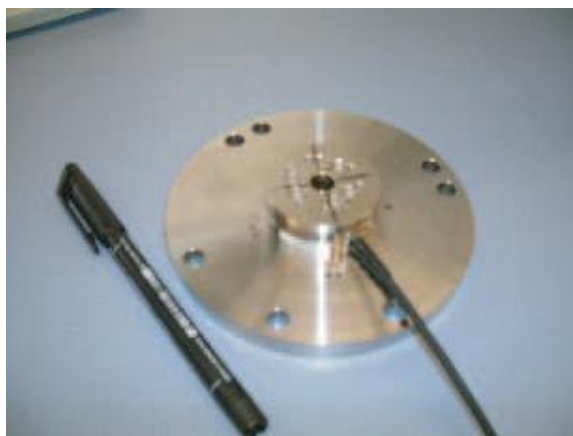
Figura 4.3: Célula de carga 6D utilizada para o novo sistema de medidas.
