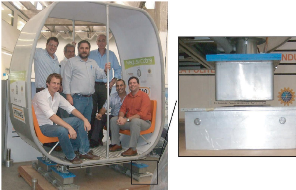
Figura 1.4: Protótipo de veículo de levitação supercondutora, em escala real, desenvolvido pelo LASUP. Destaque para o mancal linear supercondutor composto por criostatos (onde são acomodados os supercondutores) e trilho magnético.
