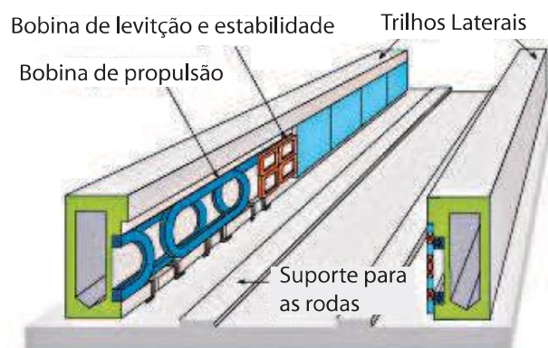
Figura 1.3: Representação esquemática de um veículo de levitação eletrodinâmica [11].
