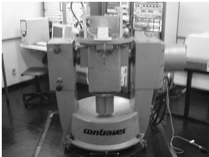
FIGURA 5.3: Foto da Mesa Simuladora de Movimento utilizada na estrutura HIL
