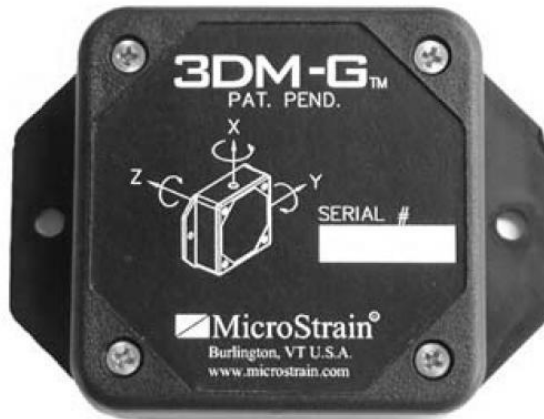
FIGURA 5.10: Foto da Unidade de Medidas Inerciais 3DM-G
