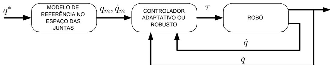
FIGURA 1.11: Diagrama em blocos para o controle de movimento.
