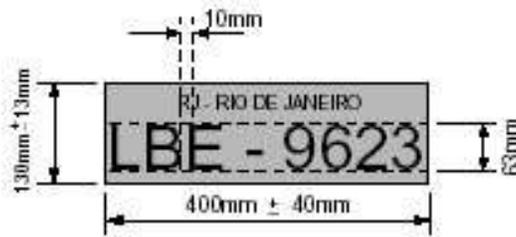
Figura 2.2: Modelo de placa de veículos brasileiros, incluindo as dimensões de altura, largura e espaçamento dos caracteres, segundo as normas definidas pelo CONTRAN.
